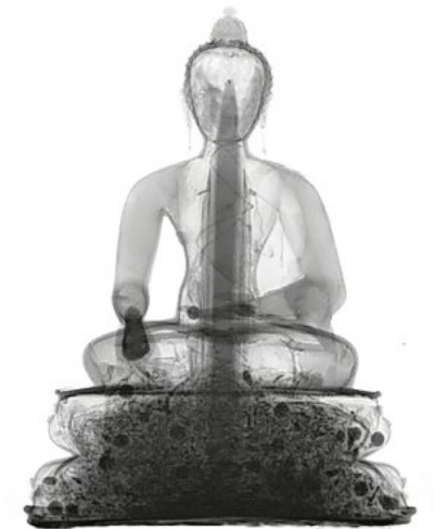
Durchleuchtung derselben Bronzefigur mit Neutronenstrahlen: Organische Substanzen sind zu sehen. Foto PSI
